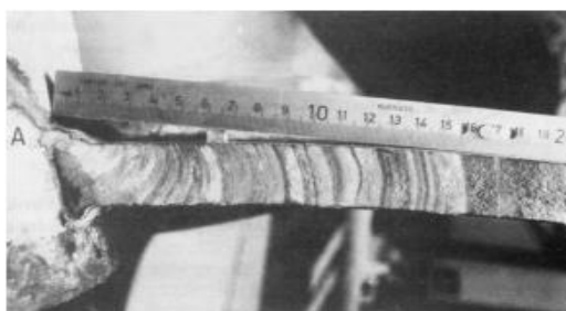
Gambar 2.11. Korosi lelah (Bardal, 2003)
