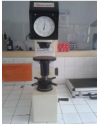
Gambar 2.13. Mesin uji kekerasan Rockwell (Laboratorium Analisis Kimia dan Metalurgi BPTM – LIPI Lampung)
