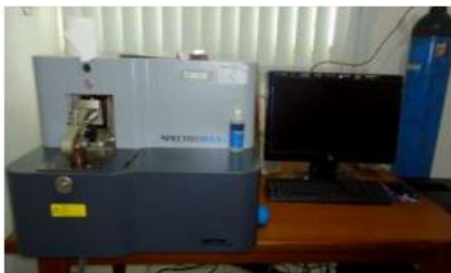
Gambar 2.15. Alat pengujian OES (Sumber: Laboratorium Analisis Kimia dan Metalurgi BPTM – LIPI Lampung).
