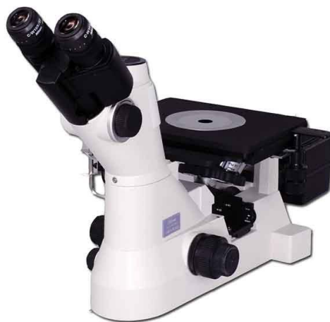
Gambar 2.19. Mikroskop metalurgi (Laboratorium Analisis Kimia dan Metalurgi BPTM – LIPI Lampung)
