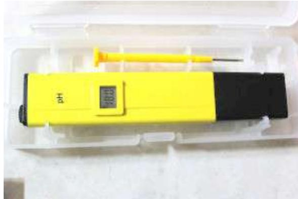
**Gambar 15. Alat Pengukur pH (pH meter)**
