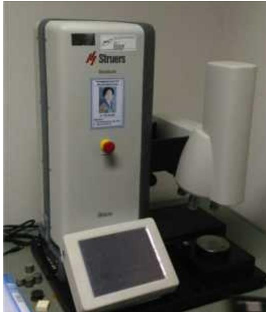
Gambar 13. Alat uji Kekerasan
