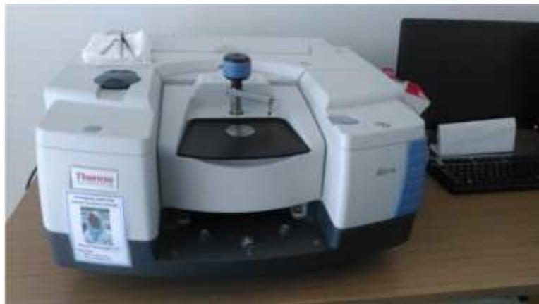
Gambar 11. Mesin FTIR
