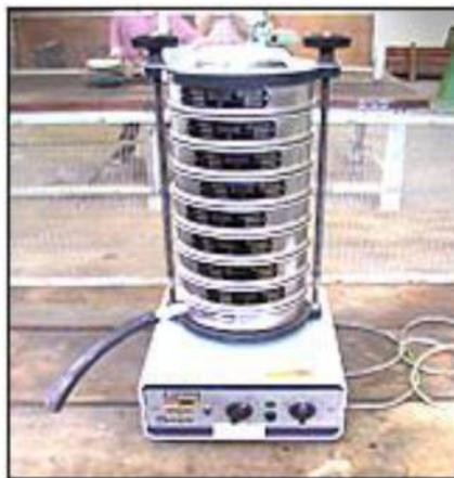
Gambar 5. Penggongcang pasir *Ro-Tap* lengkap dengan ayakan tersusun bertingkat (Desiana dkk, 2012).
