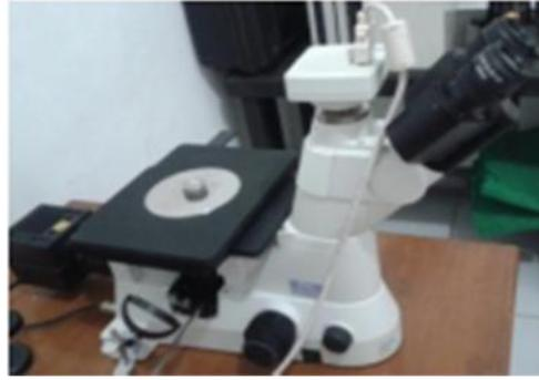
Gambar 11. Mikroskop metalurgi (Laboratorium Analisis Kimia dan Metalurgi BPTM – LIPI Lampung)
