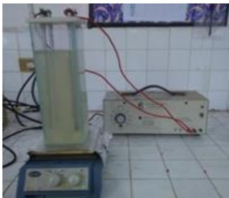
**Gambar 6.** Perangkat elektrokimia yang digunakan untuk pembuatan zeolit sintetik.
