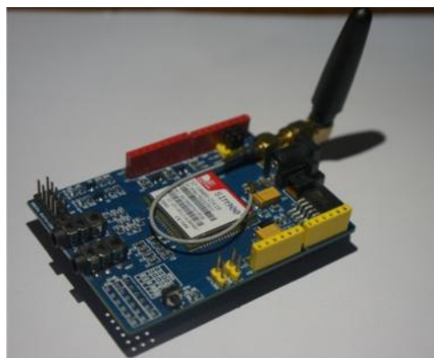
Gambar 3.2 Perangkat pengirim modul GSM/GPRS SIM900
