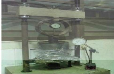
Gambar 4 . Pengujian CBR Laboratorium
