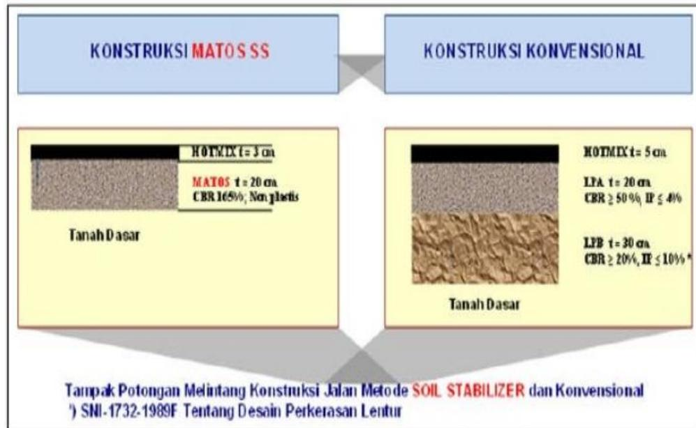
**Gambar 3.** Perbandingan lapis perkerasan jalan konvensional dan jalan dengan konstruksi *Matos* (*Soil Stabilizer*)
