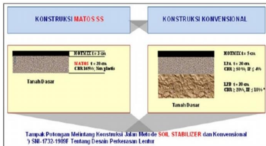
Gambar 3. Perbandingan lapis perkerasan jalan konvensional dan jalan dengan konstruksi Matos ( Soil Stabilizer )
