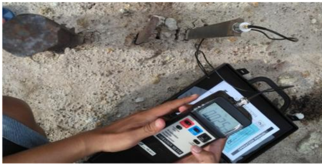
Gambar 3.6 Contoh Pengambilan data Menggunakan Vibration Meter
