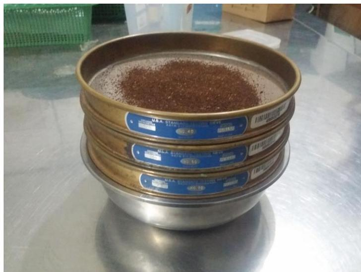
Gambar 3. Pengayakan manual sampel bubuk kopi menggunakan mesh ukuran 40, 50, dan 70
