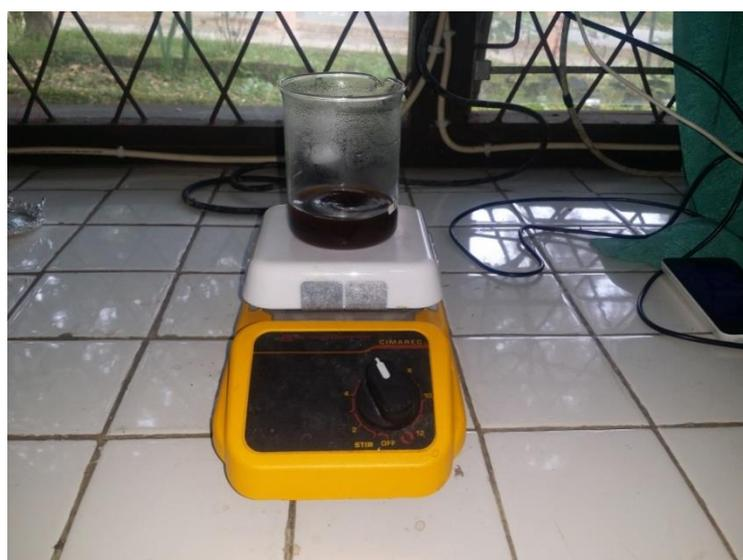
Gambar 6. Proses pengadukan sampel menggunakan *magnetic stirrer*
