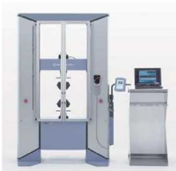
Gambar.3.11. Mesin uji tarik (Shimadzu AG - 50 kNX Plus)
