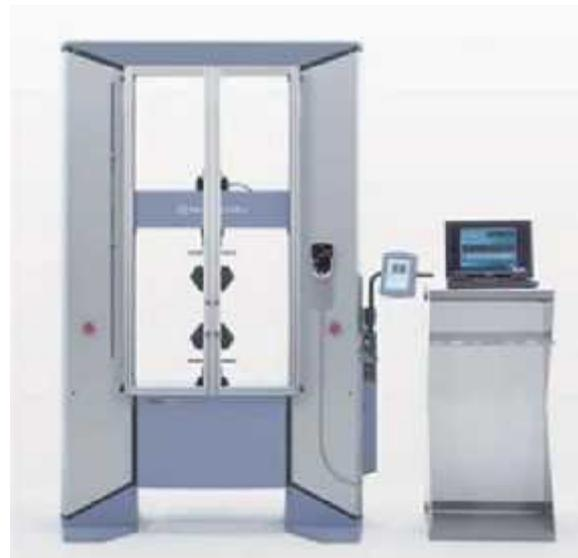
Gambar 3.14. Mesin Uji Tarik
