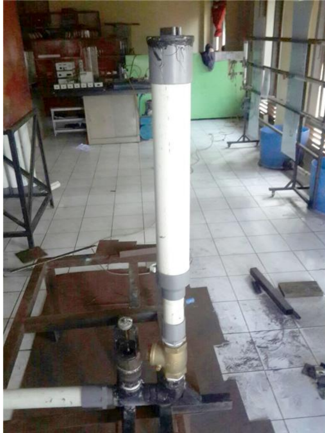
Gambar 3.6 Model pompa hydram yang diuji
