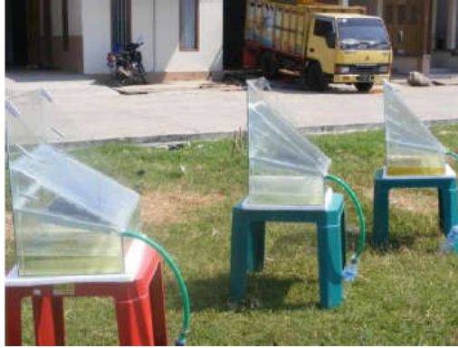
Gambar 2.1. Instalasi alat dengan variasi sudut kemiringan 20°, 30°, dan 50° (Sumber: Santosa dkk., 2010).
