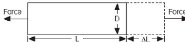
Gambar 2.6. Sebuah Gaya yang Dikenakan Pada Batang  $L$  dan Mengalami Perubahan Panjang  $\Delta L$  akibat strain (Sumber : Sulistiwaty dan Melania, 2011).
