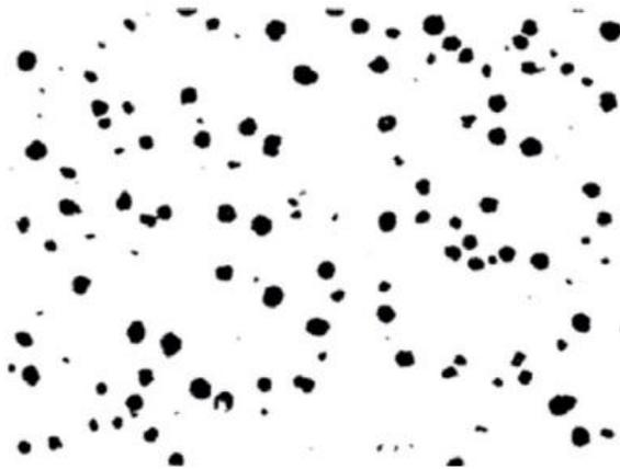
**Gambar 2.3** Bentuk grafit *spheroids* dalam besi cor liat (Reynaud, 2010)
