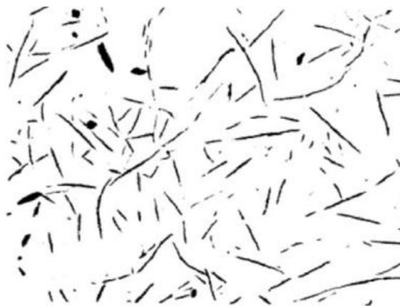
**Gambar 2.2** Bentuk grafit *flakes* dalam besi kelabu (Reynaud, 2010)
