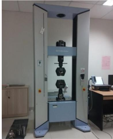
Gambar 13. Mesin uji tarik
