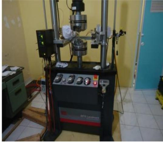
Gambar 4. Mesin uji tarik (Solihin. 2016).
