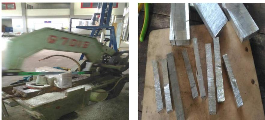
Gambar 15. Pemotongan magnesium
