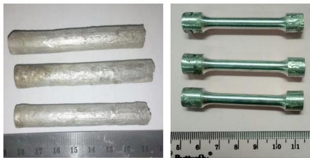
Gambar 22. Pembubutan pada spesimen uji tarik
