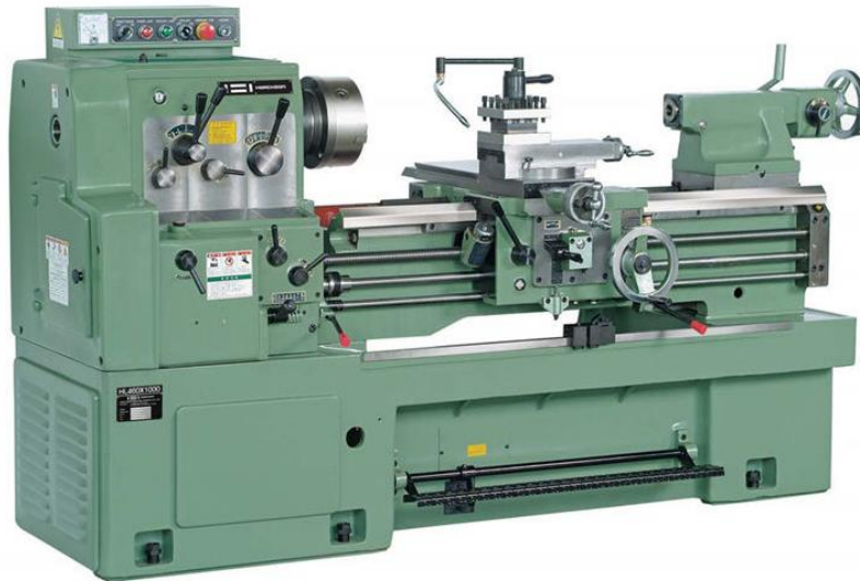
Gambar 1. Mesin Bubut (Sumber: http://diobubut.blogspot.co.id , 2014)
