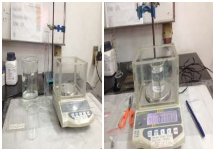
Gambar 12. Pengujian Densitas dan Porositas teori archimides
