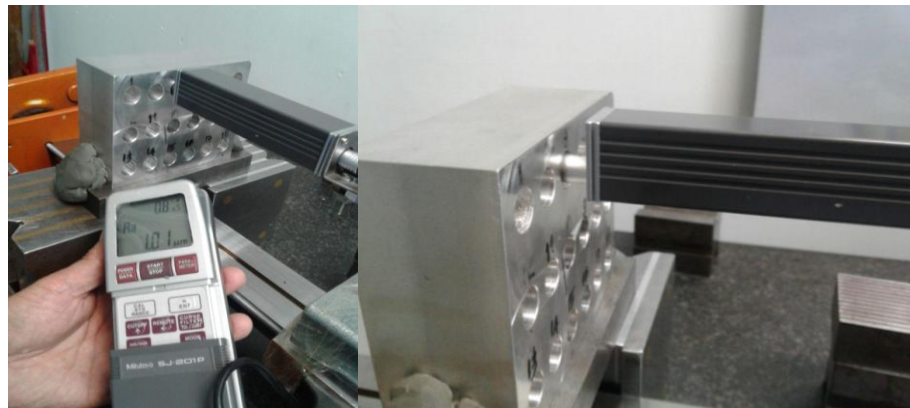
Gambar 3.9. Proses pengukuran material uji dengan Surface Test SJ-
