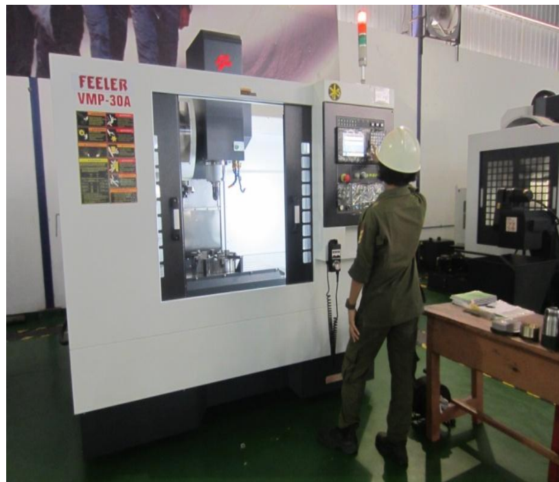
Gambar 3.6 CNC Vertical Machining menggunakan program Fanuc.
