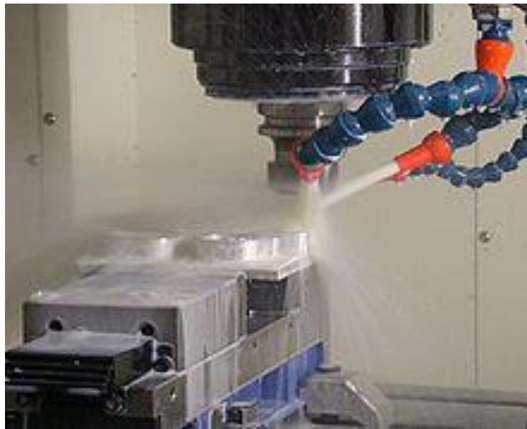
Gambar 3.5 Proses milling pada aluminium tebal menggunakan suatu cairan potong berdasar air ( water-based cutting fluid ) pada milling cutter . ( https://en.wikipedia.org/wiki/File:Makino-S33-
