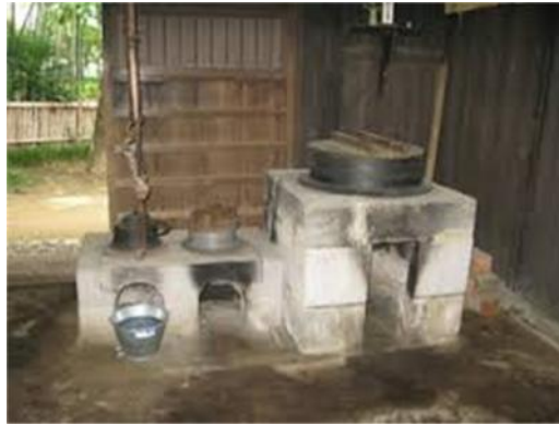
Gambar 16. Tungku kayu bakar bertingkat
