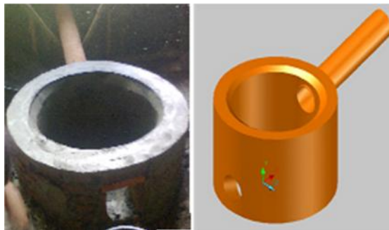
Gambar 17. Tungku hemat energi.
