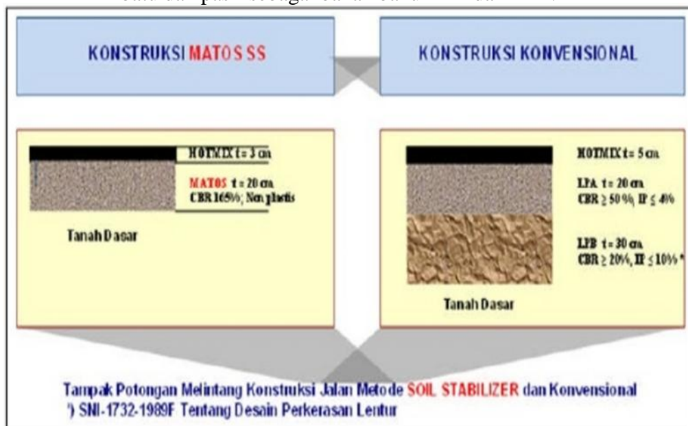
Gambar 6. Perbandingan Lapis Perkerasan Jalan Konvensional Dan Jalan dengan Konstruksi Matos ( Soil Stabilizer )
