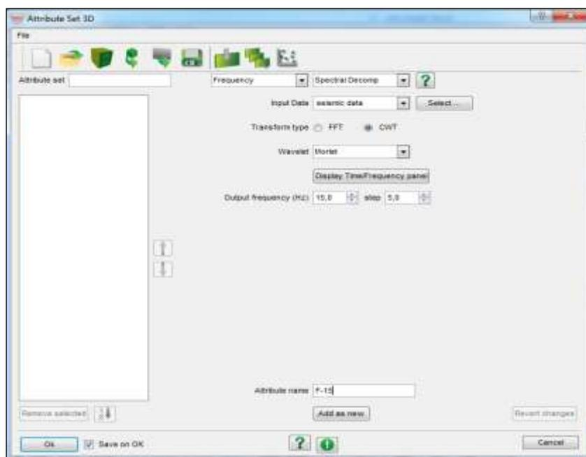
**Gambar 62.** Tampilan pengaturan atribut dekomposisi spektral pada software *OpendTect*.
