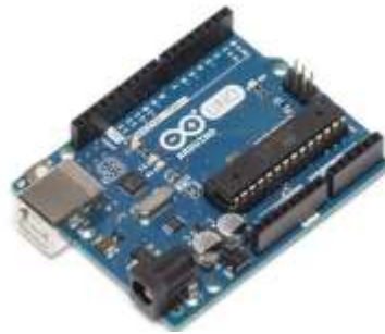
Gambar 2.5. Mikrokontroler Arduino Uno (Sumber: Massimo. (2005:14). Arduino of Ivrea ).
