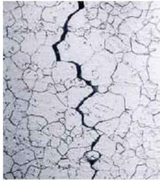
Gambar 5. Korosi retak-tegangan (Priyotomo, 2008).
