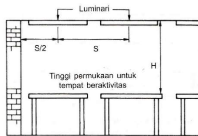
Gambar 2.9. Rasio sela jarak luminari dan ketinggian pemasangannya.
