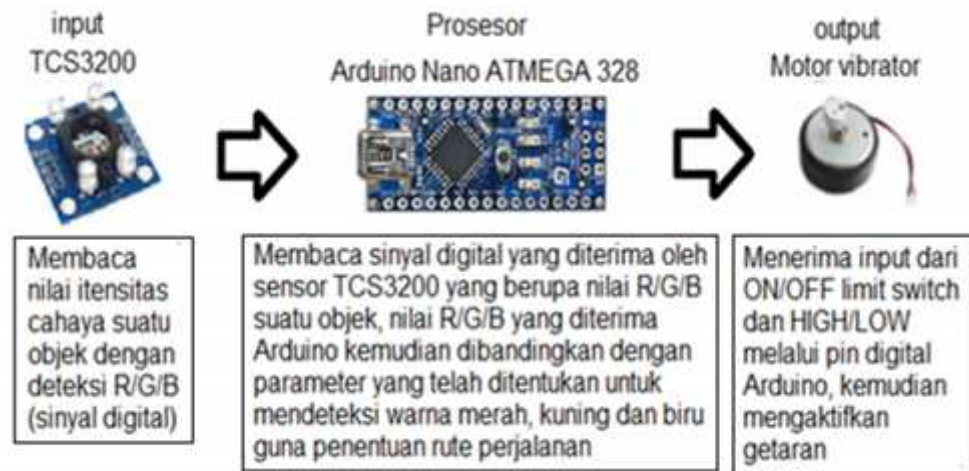
Gambar 3.6. Rancangan Blok Sensor TCS3200
