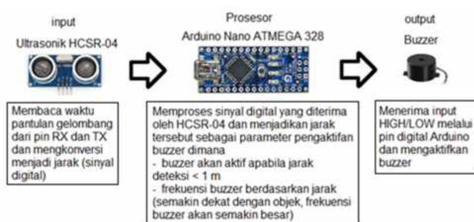
Gambar 3.4. Rancangan Blok Sensor Ultrasonik HCSR-04
