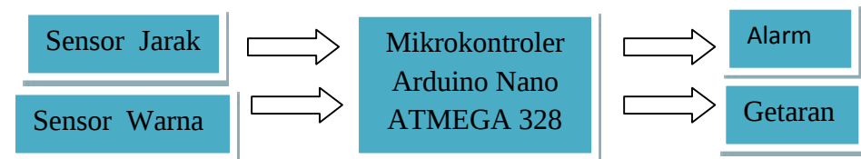
Gambar 3.2 Diagram Blok Perancangan Sepatu Alat Bantu tunanetra
