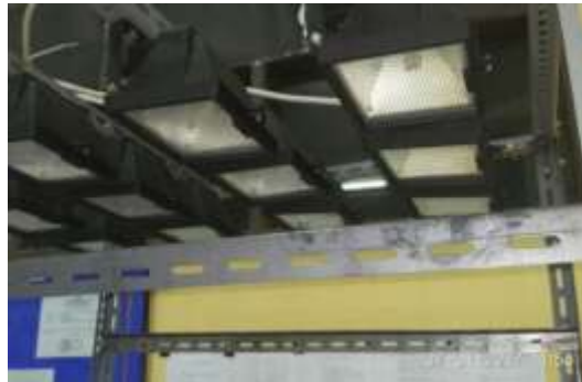
Gambar 3.6 Lampu sebagai simulator sumber panas
