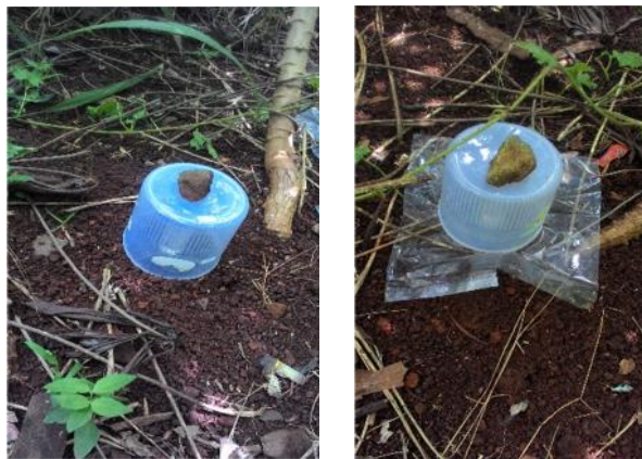
Gambar 1. Pengukuran respirasi tanah dengan metode Verstraete yang dimodifikasi
