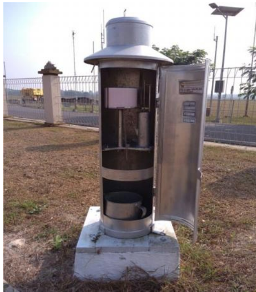
Gambar 3. Penakar hujan otomatis tipe hellman (Sumber: BMKG, 2018)
