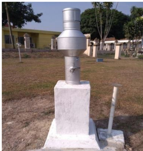
Gambar 2. Alat penakar hujan observatorium (Sumber: BMKG, 2018)
