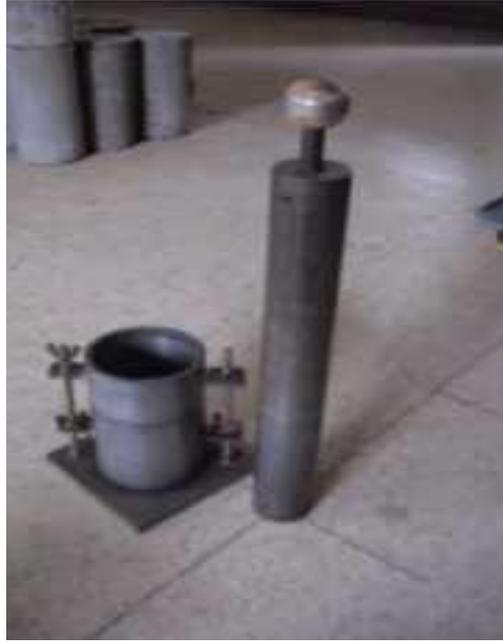
Gambar 2.2. Alat Pengujian Pemadatan Standard
