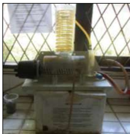
Gambar 7. Alat destilator untuk menghasilkan air mendidih dan aquades.
