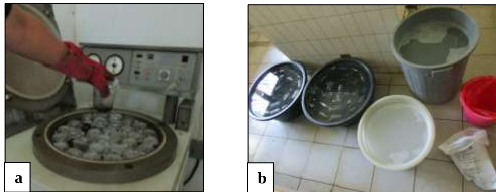
Gambar 6. Sterilisasi botol: (a) Sterilisasi botol dengan autoklaf “ Budenberg ” dan (b) proses perendaman botol kultur.
