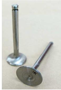
Gambar 11. Katub pada motor empat langkah
