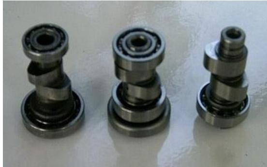
Gambar 8. Poros bubungan (*Camshaft*)
