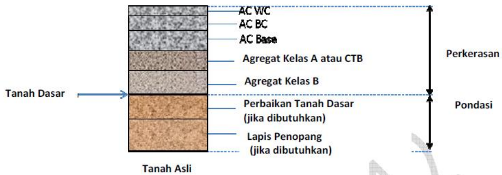
Gambar 1. Struktur perkerasan lentur pada tanah asli
