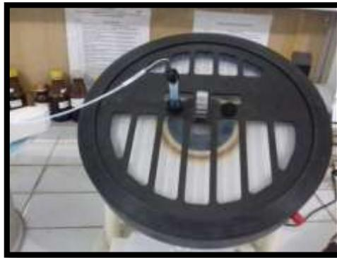
**Gambar 7.** Gambar rangkaian kromatotron.
