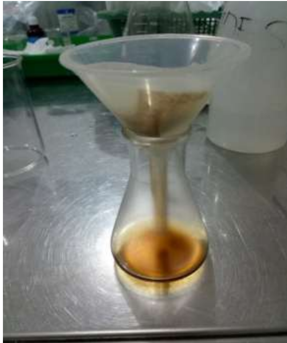
Gambar 10. Proses Penyaringan Sampel Menggunakan Kertas Saring.
