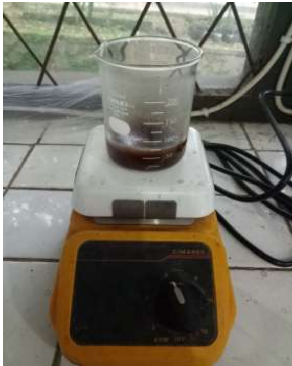
Gambar 9. Proses Pengadukan Sampel Menggunakan Magnetic Stirrer .
