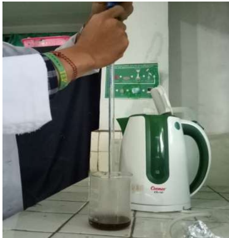
Gambar 8. Pencampuran Sampel Bubuk Kopi 1 gram dengan Akuades 50 ml pada Suhu 90 - 98°C.
