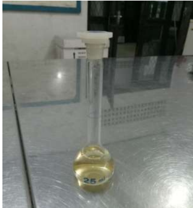
Gambar 11. Hasil Pengenceran Sampel dengan Perbandingan 1 ml Sampel Kopi dan 20 ml Akuades.
