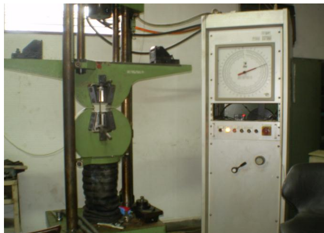
Gambar 14. Mesin uji tarik tarno grocki
