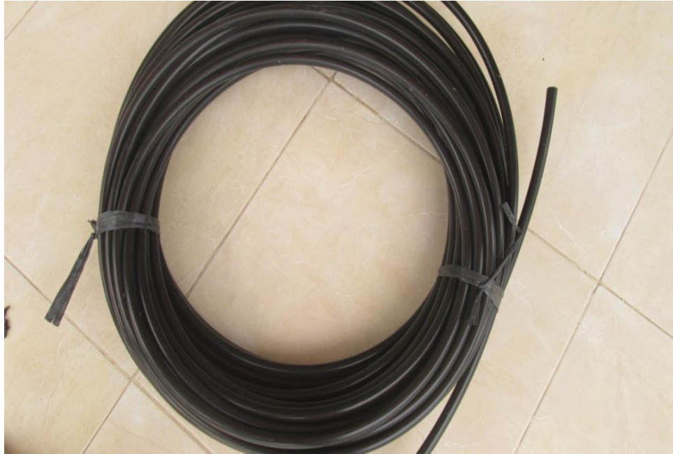
Gambar 3. Jenis selang PE yang digunakan sebagai pipa lateral, pipa sub utama dan pipa utama
