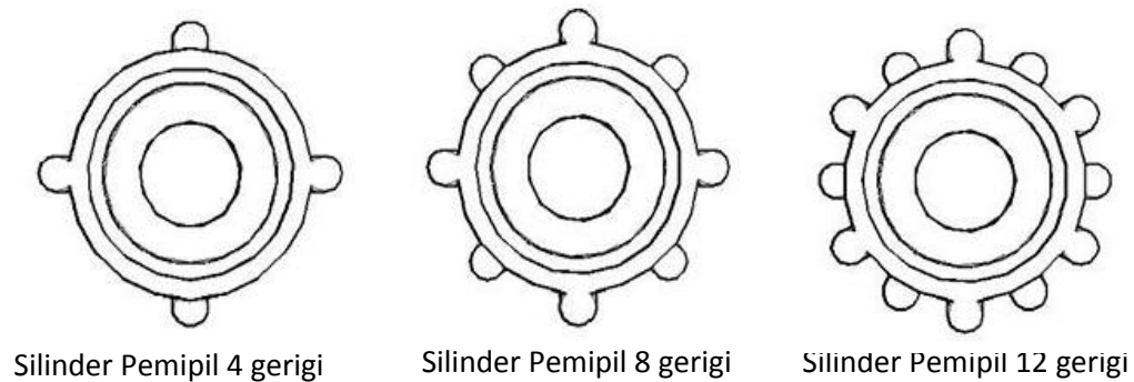
Gambar 3. Silinder pemipil yang akan dimodifikasi
