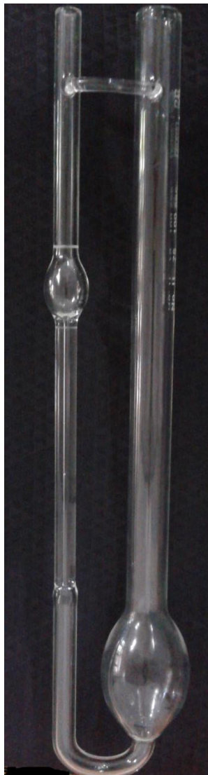
Gambar 8. Viskometer Ostwald (alat untuk mengukur viskositas)
