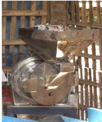
Gambar 3. Mesin penggiling
