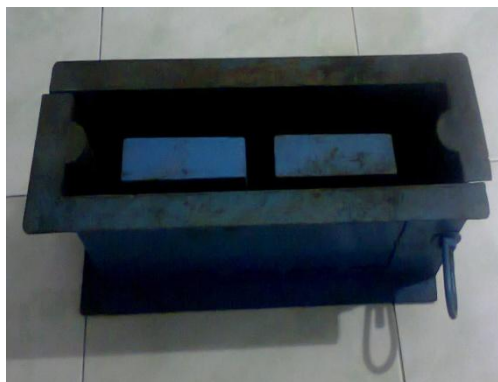
Gambar 3.1 Cetakan bata beton berlubang
