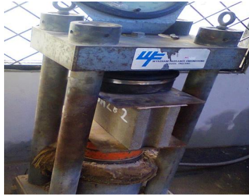
Gambar 3.5 Pengujian kuat tekan benda uji
