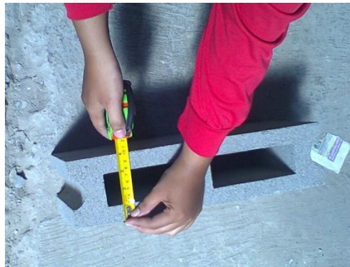
Gambar 3.4 Pengukuran dimensi benda uji
