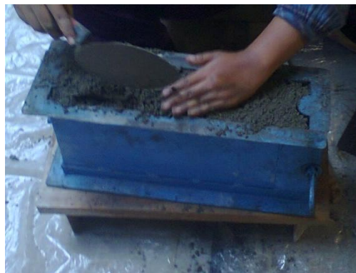
Gambar 3.2 Pencetakan benda uji
