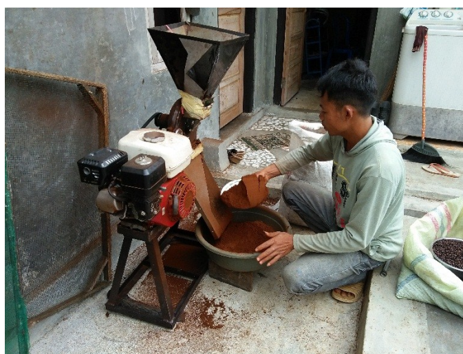
Gambar 14. Proses penggilingan biji kopi roasting menjadi kopi bubuk
