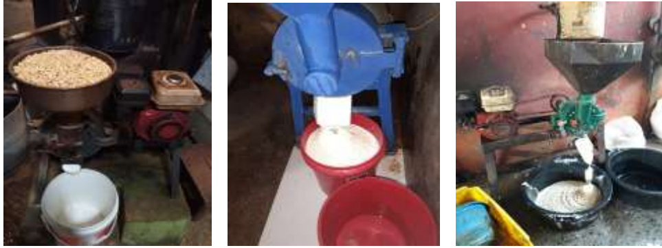
Gambar 8. Proses penggilingan kedelai agroindustri tahu skala rumah tangga, menengah, dan besar
