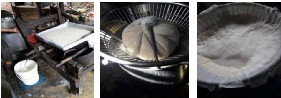
Gambar 10. Proses penyaringan agroindustri tahu skala rumah tangga, menengah, dan besar
