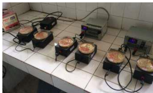
Gambar 6. Pemaparan medan magnet 0,2 mT pada benih selama 7 menit 48 detik, 11 menit 44 detik, dan 15 menit 36 detik (Dokumentasi Pribadi).
