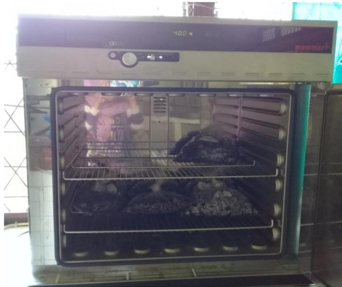
Gambar 3. Pemanasan benih kelapa sawit pada oven 40 °C
