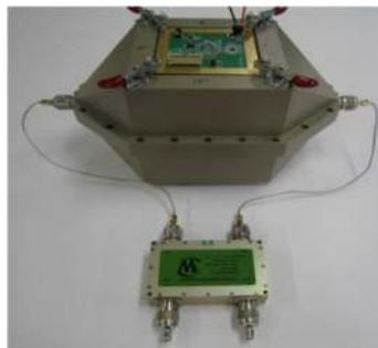
Gambar 2.5 TEM cell tipe tertutup menggunakan bahan alumunium [12]
