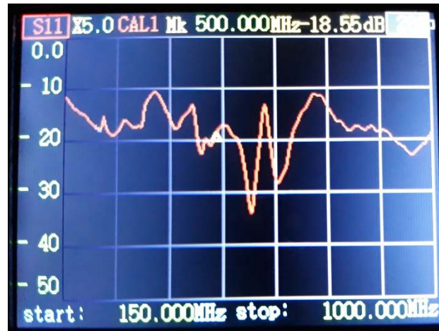
Gambar A.3 Keluaran nilai S_{11} menggunakan Vector Impedance Analyzer
