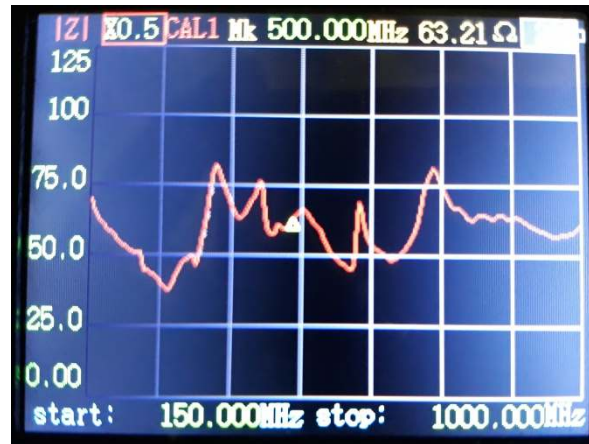
Gambar A.6 Keluaran nilai Z menggunakan Vector Impedance Analyzer
