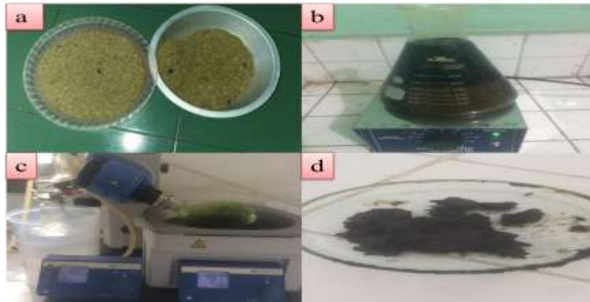
Gambar 5. Pembuatan ekstrak daun cengkeh (a) ekstrak daun cengkeh yang sudah dihaluskan (b) homogenisasi dengan magnetic stirrer (c) pembuatan ekstrak dengan rotary evaporator (d) pasta
