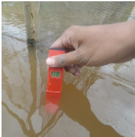
Kualitas air berupa suhu, salinitas, oksigen terlarut, dan pH diukur secara insitu
