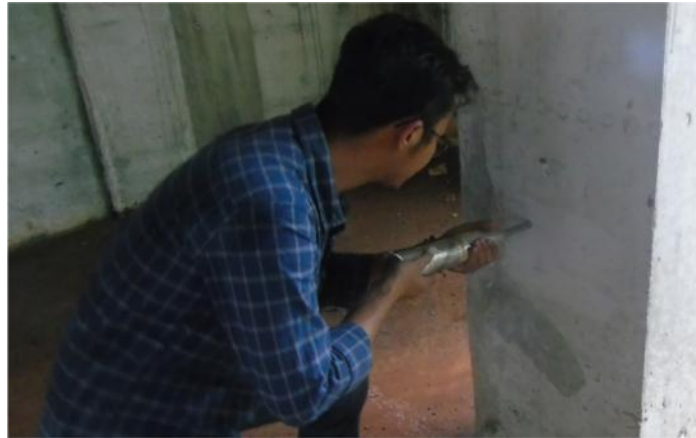
Gambar 3.3. Pengambilan data Hammer Test
