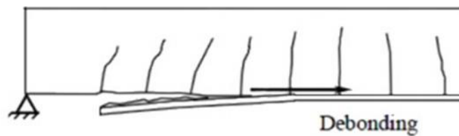
Gambar 3.12. Debonding tanpa ikutnya beton
